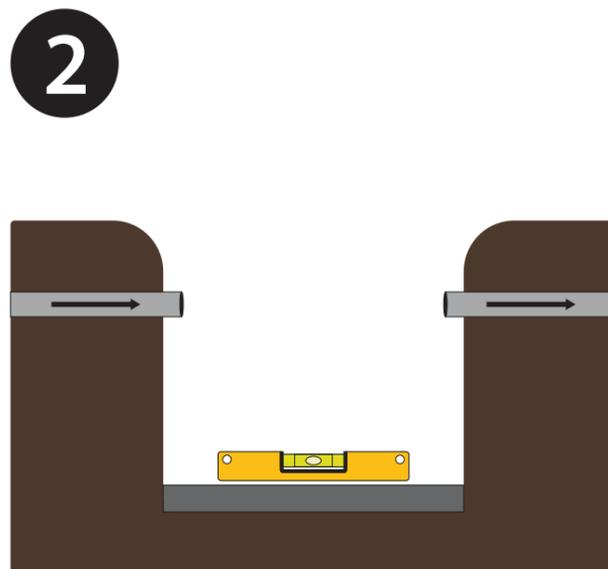
**SVE** Betongplatta monteras i gropens botten. Kontrollera att betongplattan är i våg.
