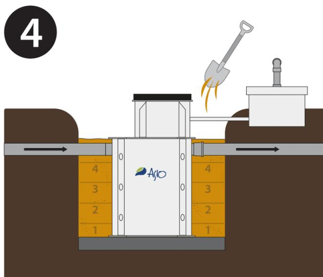
**SVE** Fyll runt reningsverket med 0-16 sand, samt vatten i reningsverket. Vibrera med ca 90 kg vibrator. Anslut rör och slangar.
